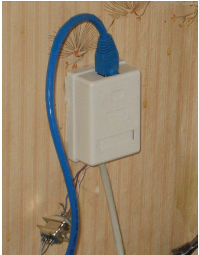
СЕТЕВАЯ РОЗЕТКА СТАЛА ЕЩЕ И СОМ-РОЗЕТКОЙ
